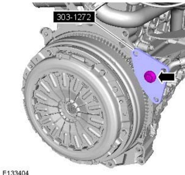
4. 注意：按照所示顺序，一次松开每个离合器压盘螺栓两圈。
